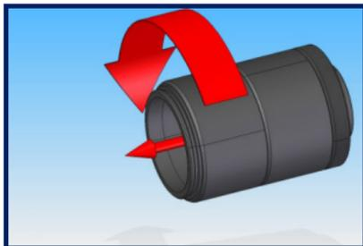
Entfernen Sie die 18mm lange 1 1/4" Verlängerungshülse des Nachführobjektivs.
