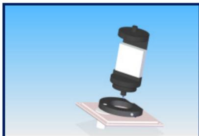
Setzen Sie den Halter des 900L-Gitters in die Andruckplatte.
