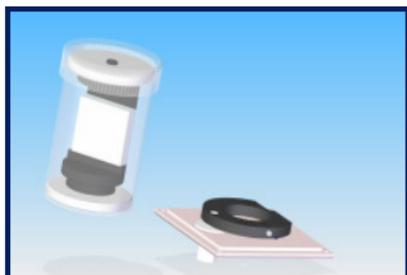
Nehmen Sie das 900L-Gitter aus dem Behälter und verstauen Sie das 200L-Gitter darin.
