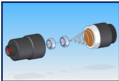
Ersetzen Sie die leeren Batterien durch zwei 1,5 Volt "Hörgeräte-" Batterien (zum Beispiel Camilion AG 3 / SR 41 #2454306).
