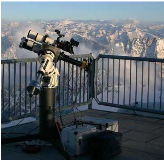
In den Wochen vor dem Ereignis wurde bereits unsere Ausrüstung ausgetestet: Apochromatische Refraktoren von Astro Physics und Zeiss mit Herschelkeilen, einem Solar Spectrum Research Grade Halpha Filter mit 0.2 A Durchlass, sowie unser neuer UV-Filter. Als Kameras kamen eine Webcam, eine SBIG ST-2000XME CCD Kamera und zwei digitale Spiegelreflexkameras von Canon und Fuji ins Gepäck. Das alles sollte auf einer Astro Physics 900 GTO mit kurzer transportabler Säule montiert werden.
