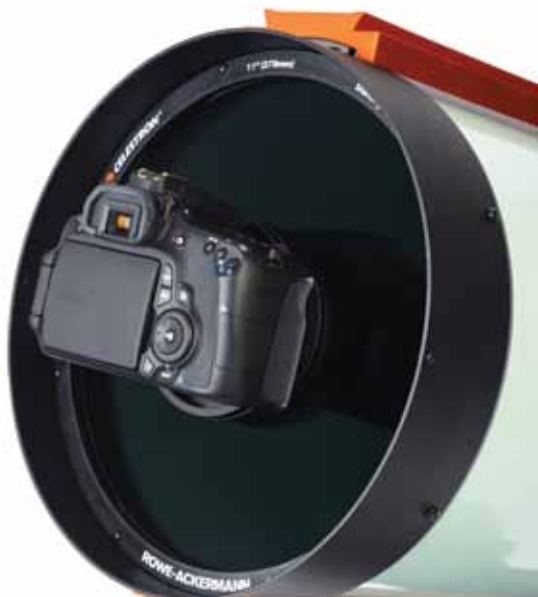
Abb. 21: Eine DSLR am RASA. Die orangefarbene Schwalbenschwanzschiene oben auf dem Tubus ermöglicht die Montage von weiterem Zubehör.
