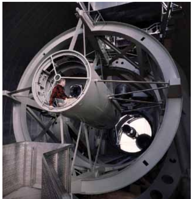
Abb. 8: In der Zeit des Hale 5-Meter-Teleskops fotografierten die Astronomen den Himmel vom Primärfokus aus. Heute kann eine CCD-Kamera im Primärfokus von Amateurteleskopen montiert werden. Foto: LIFE
