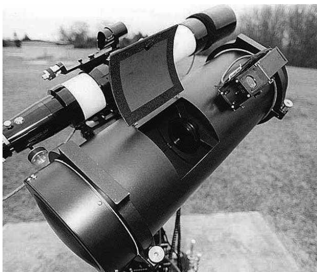
Abb. 5: Celestrons 8-Zoll f/1,5 Schmidtkamera ermöglichte auch Amateuren die Großfeld-Astrofotografie mit kurzen Belichtungszeiten und scharfen Bildern auf Kodaks bemerkenswertem Tech-Pan Film. Foto von Kent Kirkley.
