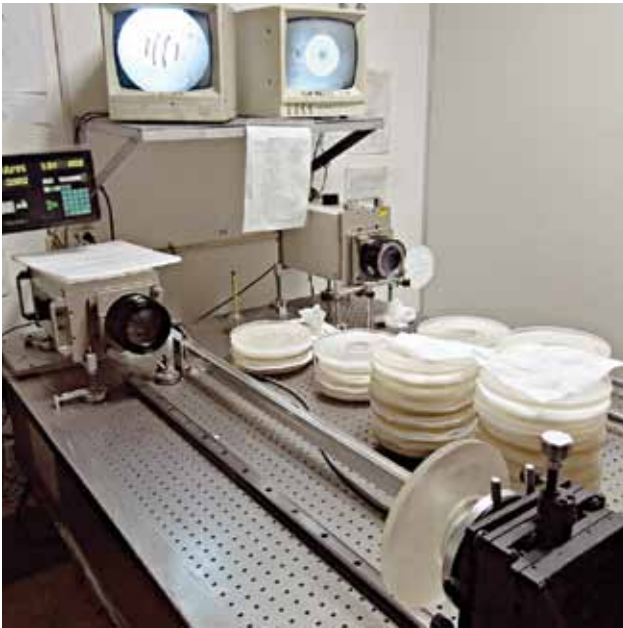
Abb. 15: Alle RASA-Hauptspiegel werden auf der optischen Bank mittels Laserinterferometrie getestet. Auf diesem Bild warten einige Stapel polierter Spiegel auf Ihre Tests.
