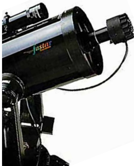
Abb. 6: Das 8-Zoll f/2 Fastar trug eine PixCel CCD Kamera vorne an der Schmidtplatte. Bei einem schnellen Teleskop liegt der beste Platz für eine kompakte Kamera im Primärfokus.
