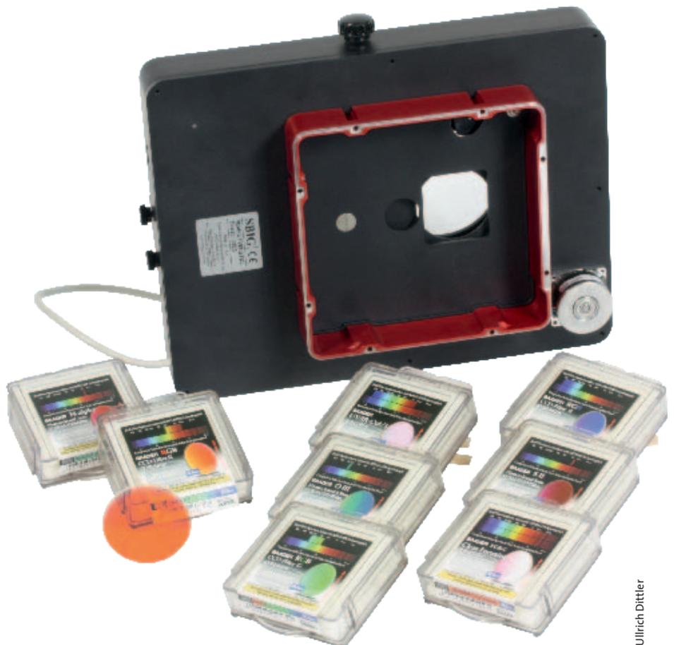
Der Aufnahmechip kann thermoelektrisch bis zu 60 Grad unter die Umgebungstemperatur gekühlt werden, wobei die gewählte Temperatur während der Aufnahme auf 0,1 Grad Celsius konstant gehalten wird. Eine noch tiefere Kühlung des Chips ist über die optional erhältliche Wasserkühlung möglich. Die ohne Filterrad 2000 Gramm wiegende Kamera verfügt zudem über einen beleuchteten mechanischen Shutter, der die Aufnahme von Dunkelbildern vereinfacht.
