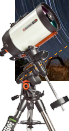
Eine parallaktische Montierung wie die Celestron AVX ist ideal für die Fotografie: Eine Achse zeigt auf den Himmelspol und gleicht die Erddrehung aus. Baader Planetarium
