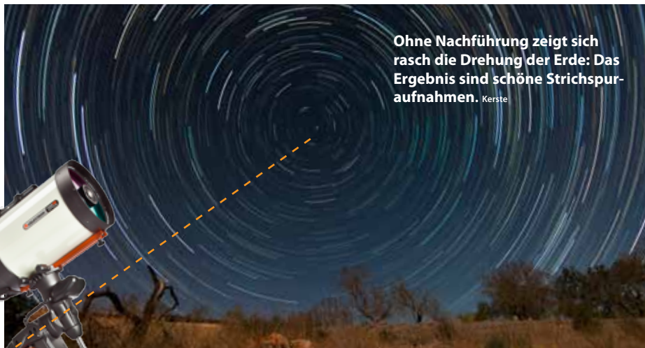
Eine parallaktische Montierung wie die Celestron AVX ist ideal für die Fotografie: Eine Achse zeigt auf den Himmelspol und gleicht die Erddrehung aus. Baader Planetarium
