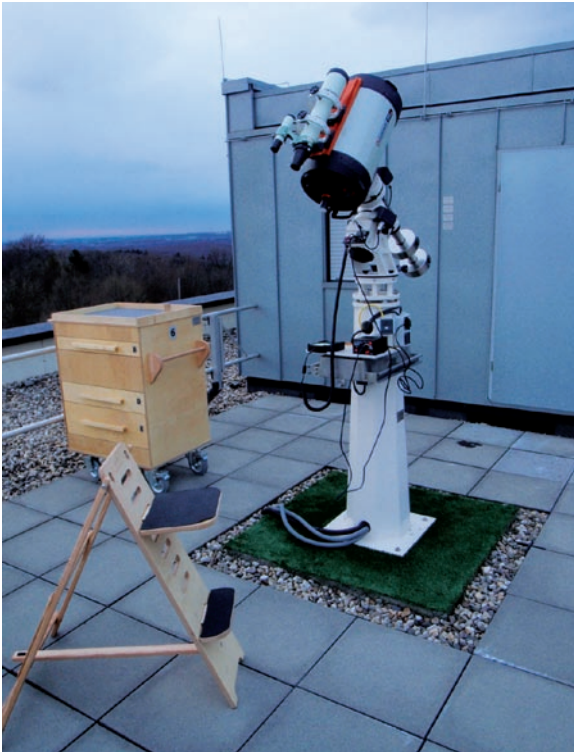
Abb. 3 Mit wenigen Handgriffen lässt sich das Teleskop aufsetzen, Strom und EDV-Anschlüsse sind schnell hergestellt. Links hinten ist der Zubehörowagen zu sehen, der u. a. den Teleskopaufsatz enthält sowie weiteres Material.
