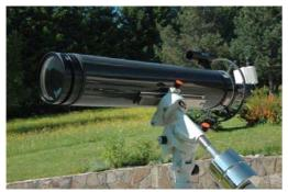
"In-Sider"-Objektiv: Die Justiervorrichtung liegt im Tubusinneren, dadurch kann nach außen die massive Fassung bündig mit der Taukappe abschließen ...
