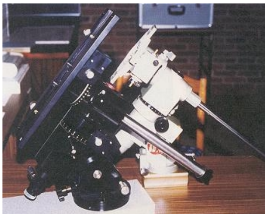
Abb. 1 (links): Größenvergleich zwischen der alten DX-Montierung (grün) und der neuen CNC 400 von Astro Physics. Die groß dimensionierte Schwalbenschwanzführung ist deutlich zu sehen.
