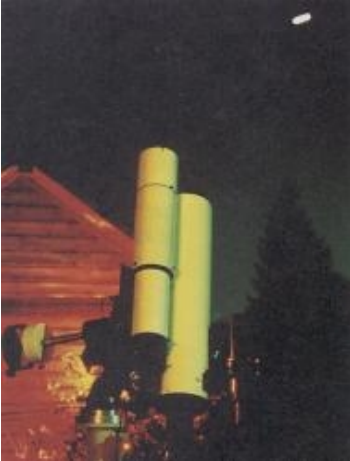
Abb. 4 (rechts): Mein 125/1900-mm-Schaer-Refraktor (FH-Objektiv von Lichtenknecker), Tubusdurchmesser 300 mm.
