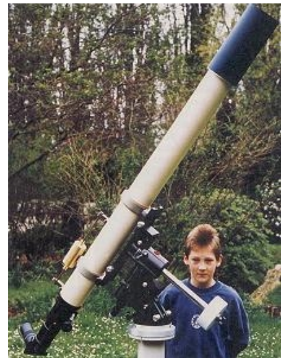
Abb. 5: Selbstbausonnenrefraktor (90/1750 mm) mit Protuberanzenansatz.
