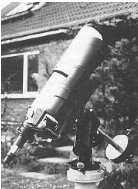
Abb. 7. Ein Zeiss-Teleobjektiv (500 mm/f:5) mit einer Kamera Pentacon Six zusammen mit dem 85/800-mm-Leitrohr, montiert auf der Montierung CNC 400 von Astro Physics.
