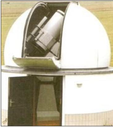
Abb. 4: Für die Volkssternwarte in Drebach (Sachsen) hat Baader Planetarium eine komplette Beobachtungsstation mit einem 0.52-m-Ritchey-Chretien-Spiegel und einer 4-m-Kuppel hergestellt und montiert. (Bild: Baader Planetarium)
