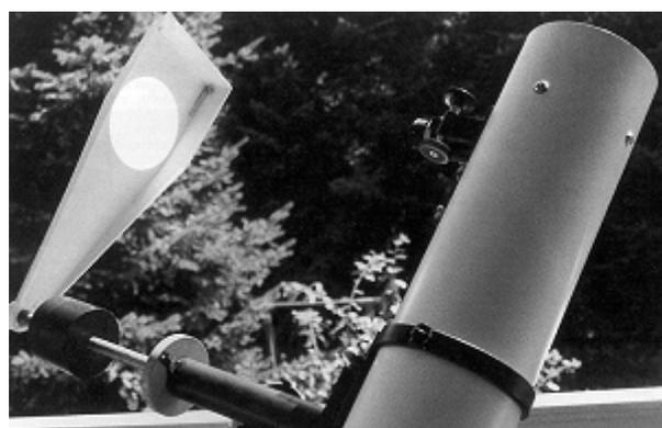
Auch an die Sonnenbeobachter wurde gedacht: Neben einem Sonnenprojektionsschirm, der auf originelle Weise (Abb. 8) auf die Gewichtsachse montiert wird, können mit Hilfe der Baader Sonnenfilterfolie gefahrlose Beobachtungen unseres Tagesgestirns vorgenommen werden.
