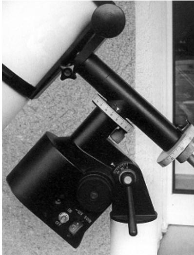
**Abbildung 4:** Die stabile Montierung bietet zahlreiche Verstellmöglichkeiten für den praktischen Einsatz. Der ordnungsgemäße Betrieb des Synchronmotors wird über eine rot leuchtende LED angezeigt.
