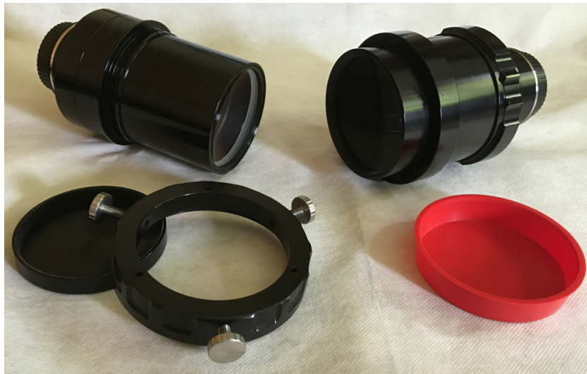
Abbildung 2: Links der 0,72x-Reducer von Astro-Physics mit aufgeschraubtem Adapter für die Canon EOS und Befestigungsring für die Adaption am OAZ, rechts der originale TEC Field Flattener.
